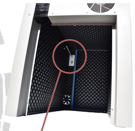
**NOTA:** La cabina cuenta con dos sondas de temperatura, una para controlar la velocidad de los ventiladores y la otra para evitar sobrecalentamientos.
